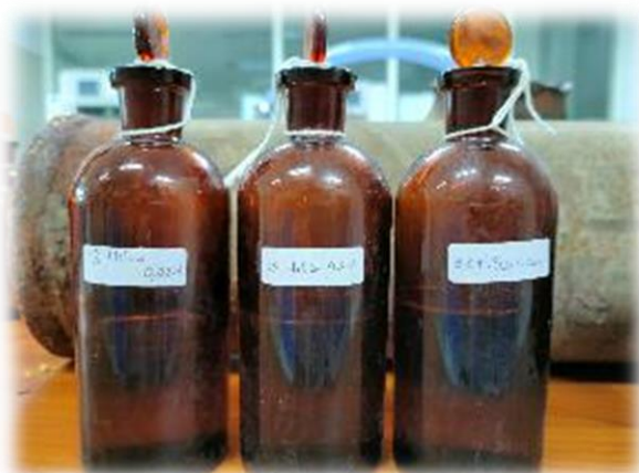
Hasil Sintesis Aditif Organik Scale Removal dengan Katalis H 2 SO 4
