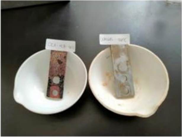
Gambar 4. Kondisi Sampel Coupon AISI CS-1018 setelah Pengujian Laju Korosi pada Temperature 100 °C
