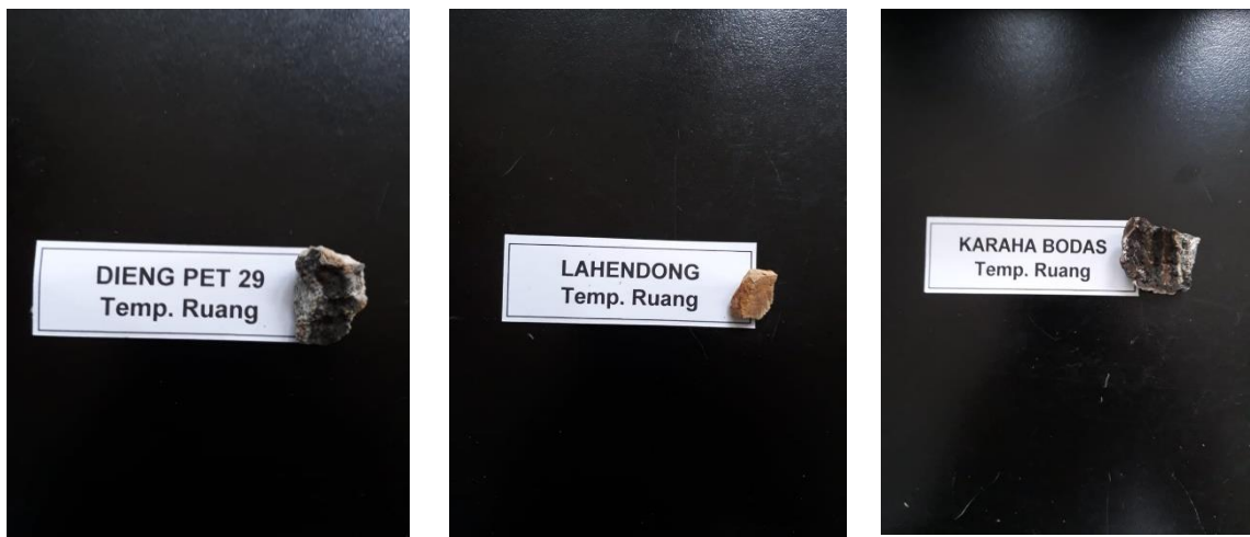
Gambar 2.7. Contoh Scale Silica yang dari beberapa lapangan Panas Bumi
