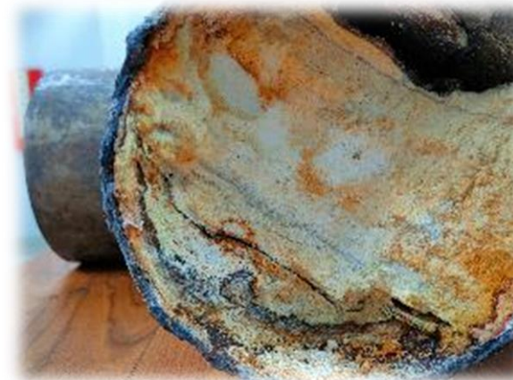
Contoh Scale Silika dalam Pipa
