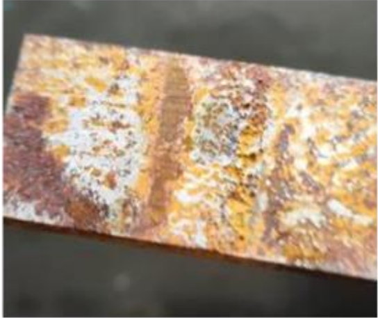
Gambar 6. Kondisi Sampel Coupon AISI CS-1018 setelah Kontak dengan OCA @ temperatur ruang
