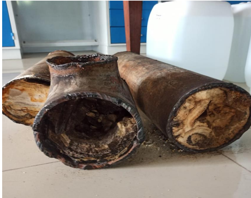
Gambar 2.4. Contoh Scale Carbonate yang terdapat di dalam flowline pipa produksi pada lapangan Migas
