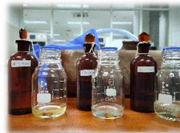
Uji Coba Kereaktifan 3% Aditif (HCl; H 2 SO 4 ; P-TSA)
