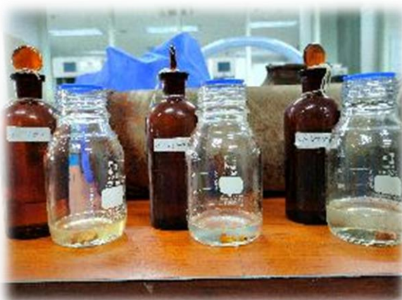
Uji Coba Kereaktifan 2% Aditif (HCl; H 2 SO 4 ; P-TSA)
