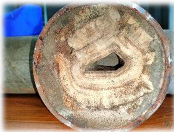
Contoh Scale Karbonat dalam Pipa
