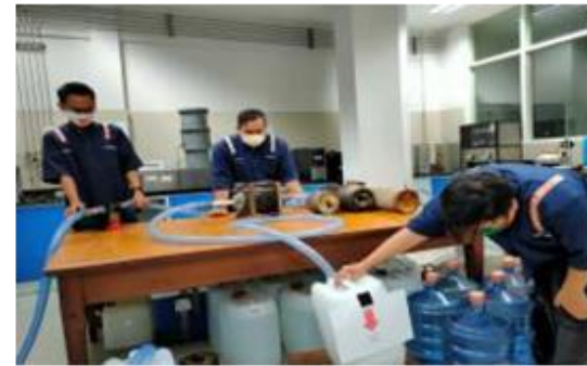
Pengamatan terhadap serpihan-serpihan sampel kerak yang mulai terlepas dari dalam pipa
