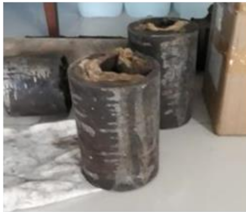
Potongan Sampel Pipa yang terdapat kerak
