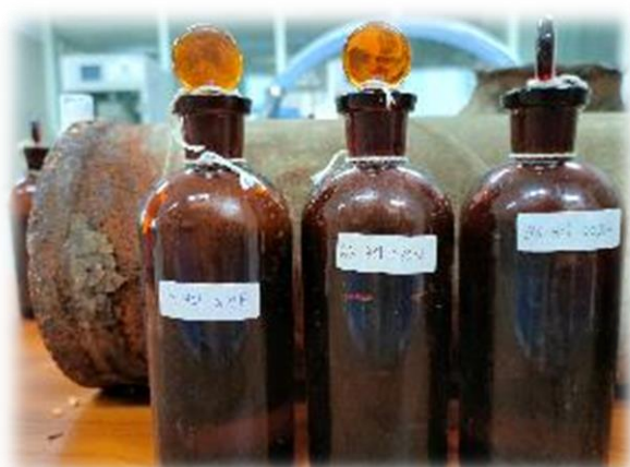
Hasil Sintesis Aditif Organik Scale Removal dengan Katalis HCl
