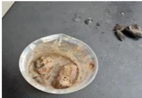
Sampel serpihan kerak dalam pipa yang keluar bersama aliran aditif setelah 2 jam penginjeksian
