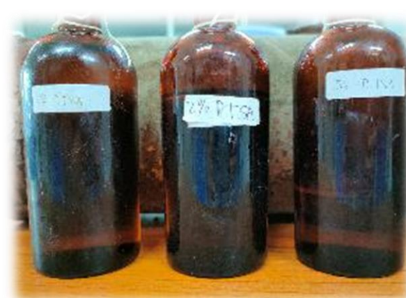
Hasil Sintesis Aditif Organik Scale Removal dengan Katalis P-TSA
