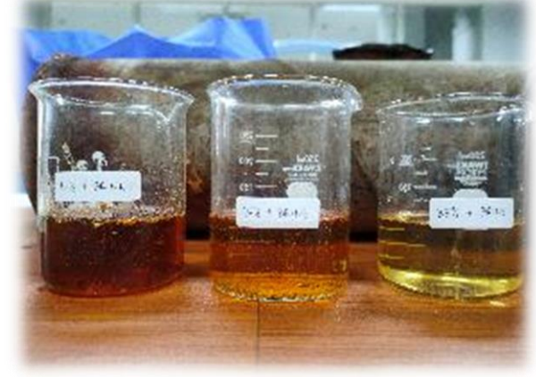
Uji Coba Pengaruh Penambahan Konsentrasi Aditif Organic Scale Removal dalam sampel Brine
