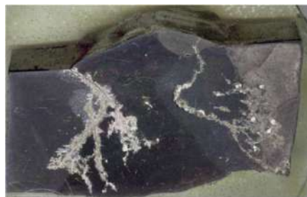
Gambar 2. Retakan pada Logam Akibat LME
