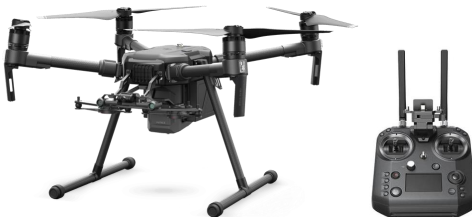
Gambar II-12. Drone Matrice 200 v2. UAV (kiri) dan remote control (kanan).
