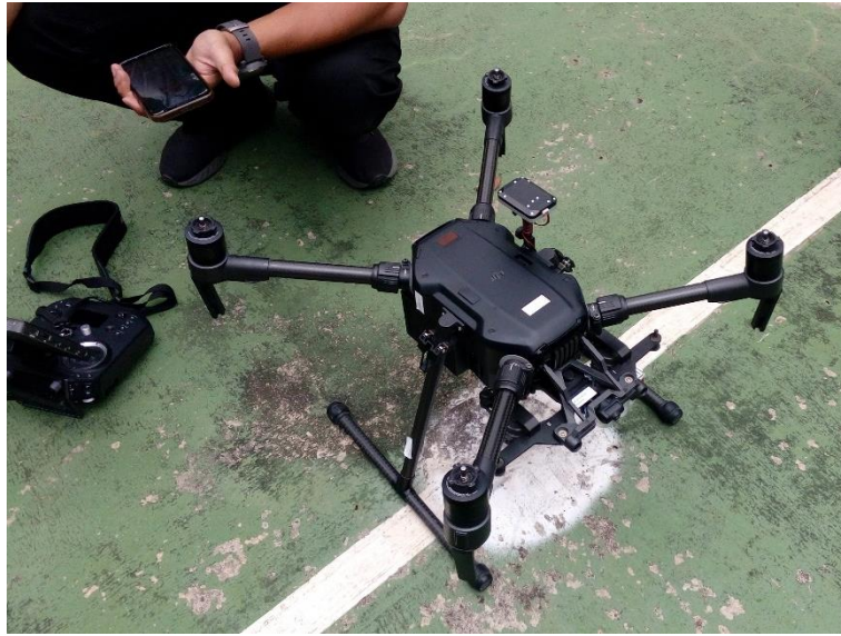
Gambar II-16. Koneksi drone dan kamera multispektral dengan pengendali.
