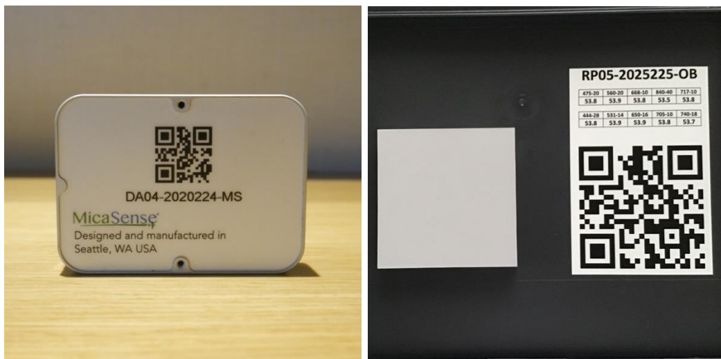
Gambar II-11. Sensor cahaya (kiri) dan papan kalibrasi (kanan) dari Micasense.
