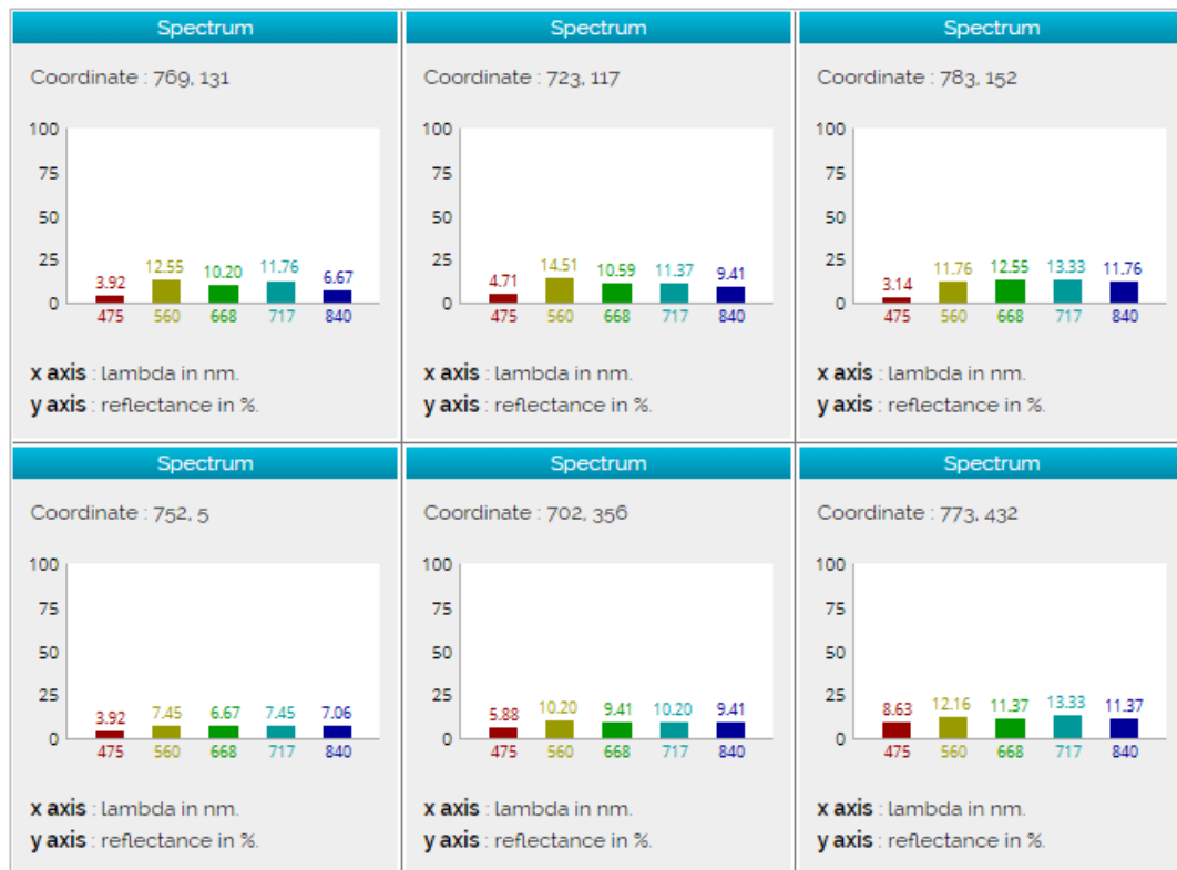
Gambar II-129. Spektrum dari 6 titik sampel pada data misi 1 di lokasi 1.
